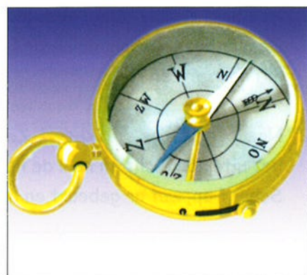
In een kompas zit een ijzeren naald. De naald is magnetisch. Hoe je het kompas ook vasthoudt, de naald wijst altijd naar het noorden.
